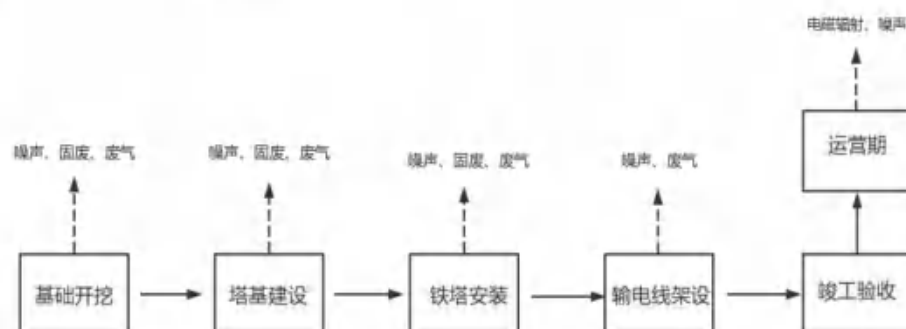
图 2-3 输电线路施工工艺时序图
