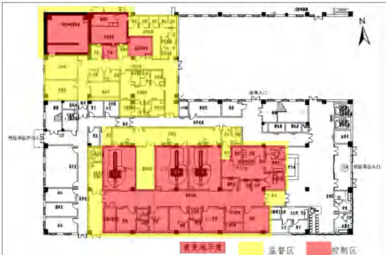
图 10.1.1.2-1 核医学科核素制备场所和核素诊断场所两区划分示意图
