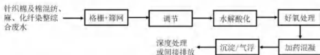
图 6.2.2-6 针织棉及棉混纺染整、麻染整以及化纤染整的综合废水常规处理工艺流程图
