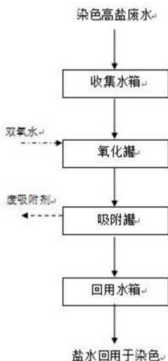
图 6.2.2-1 染色高盐废水回用处理工艺流程
