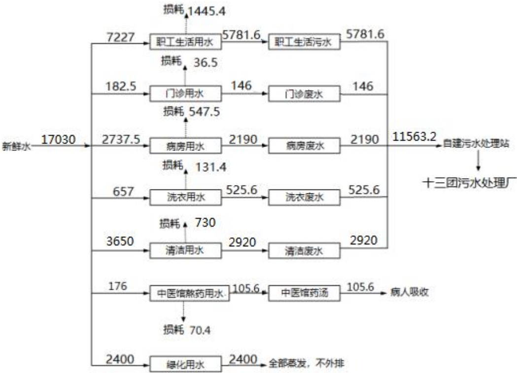
11563 图 2-1 本项目水平衡图 单位：t/a
