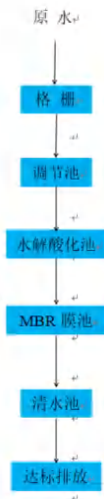
图 6-1 污水处理站工艺流程图
