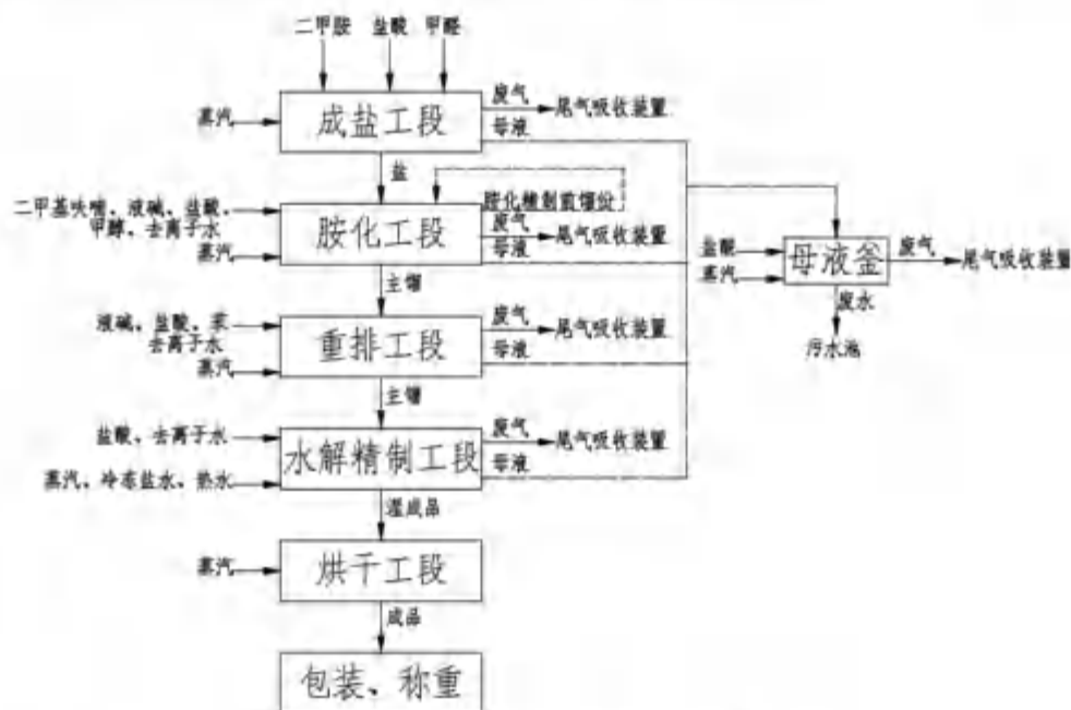
图4-2 项目生产工艺及产污流程图
