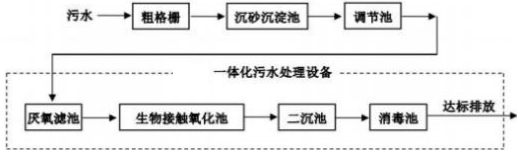
图 4-1 一体化污水处理设施工艺流程图
