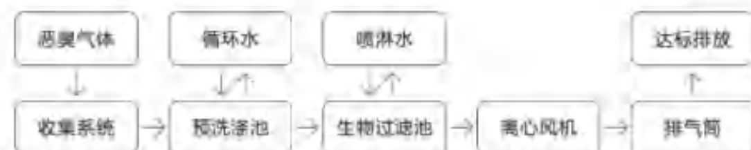
图 6.1-3 废气处理工艺流程图
