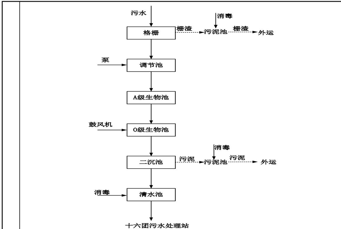
图 2-3 项目自建污水处理站处理工艺及产污环节图
