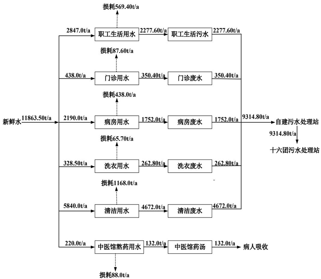
图 2-1 本项目水平衡图 (t/a)
