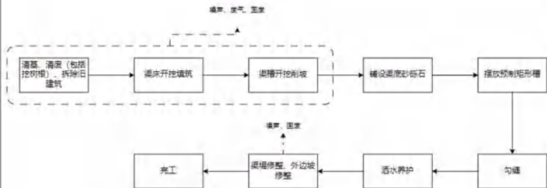
图 2-10 矩形渠道施工期工艺流程及产污环节示意图
