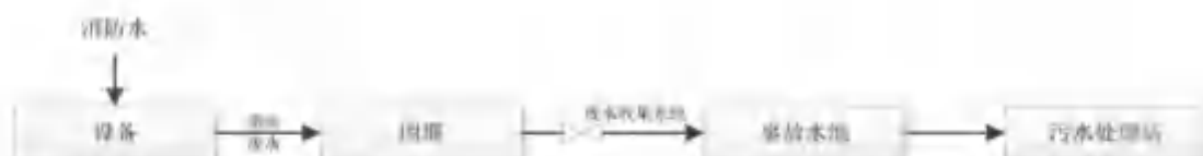
图 5.3-2 燃烧时消防废水传输图
