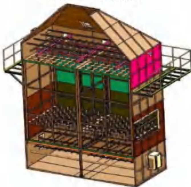
图 6.2.1-3 静电除油内部结构图
