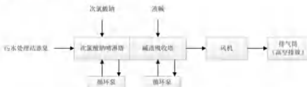
图 6.2.1-5 污水处理站废气处理工艺流程图
