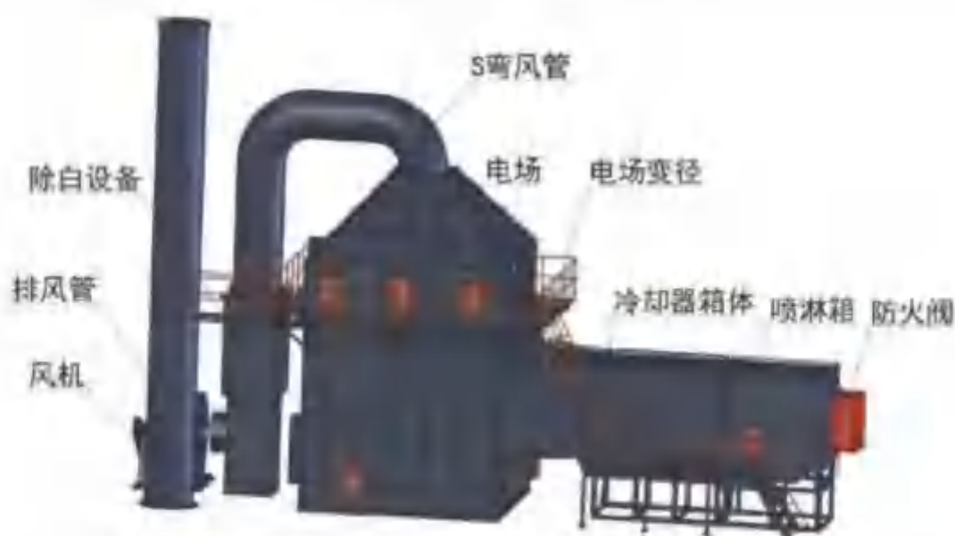
图 6.2.1-4 “水喷淋+间接冷却+静电净化”设备示意图
