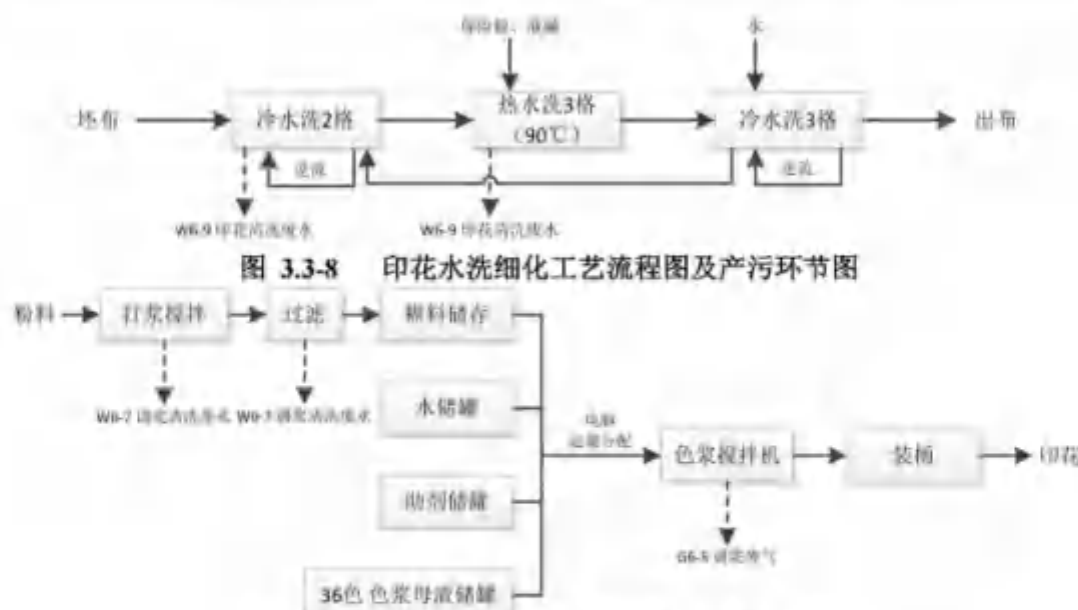
图 3.3-9 自动调浆细化工艺流程图及产污环节图
