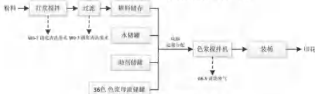
图 3.3-9 自动调浆细化工艺流程图及产污环节图
