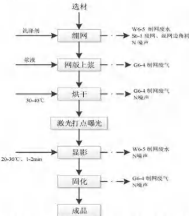
图 3.3-11 平网蓝光制网细化工艺流程图及产污环节图
