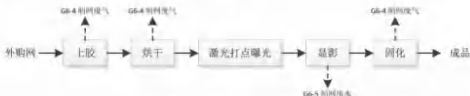
图 3.3-10 圆网蓝光制网细化工艺流程图及产污环节图
