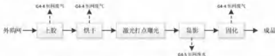
图 3.1-7 圆网蓝光制网细化工艺流程图及产污环节图
