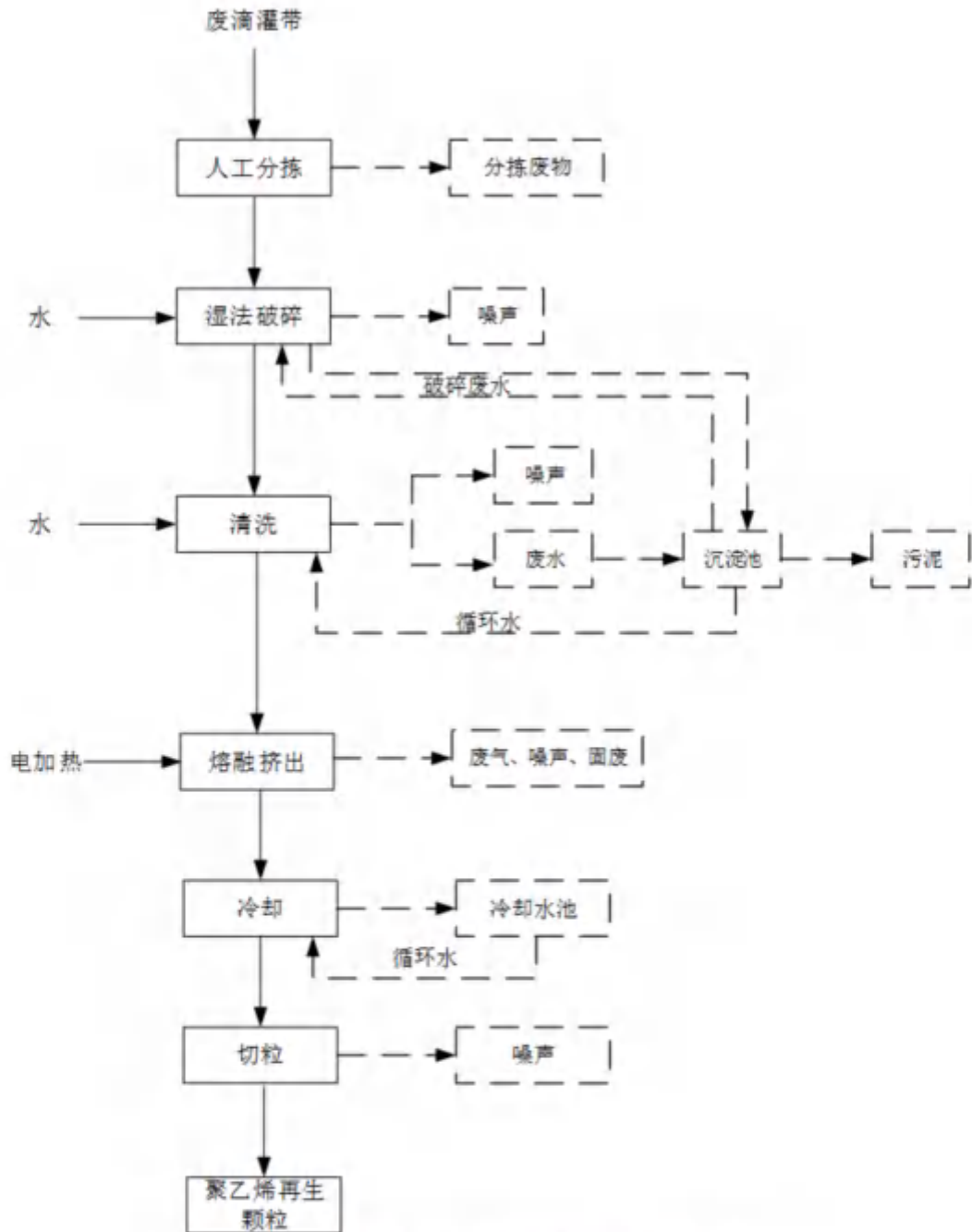
图 3.2-2 造粒工段工艺流程及产污节点图
