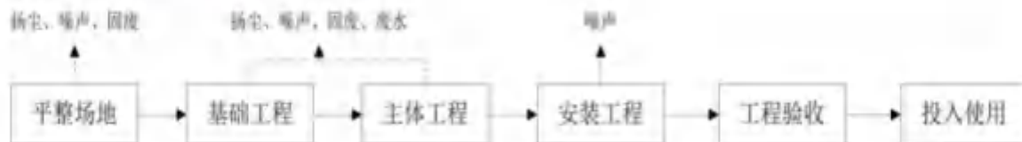
图 3.2-1 施工期工艺流程及产污环节图
