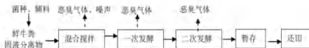
图 3.4-6 有机肥生产工艺流程及排污节点示意图
