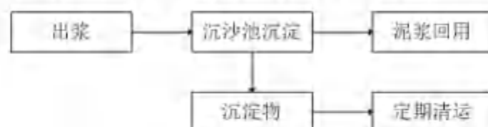
图 2.7-5 桥梁钻孔泥浆流程
