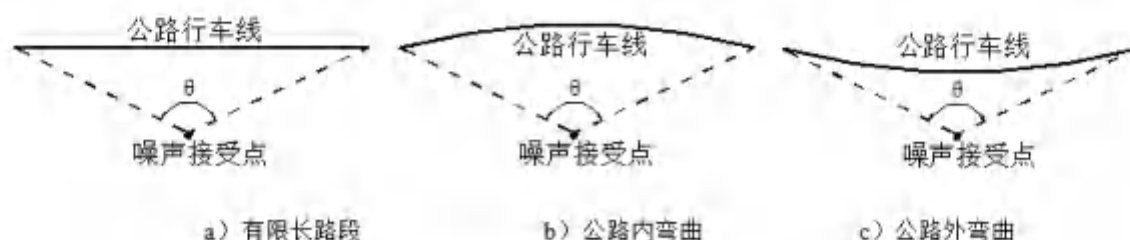
图4.4-1 预测点到有限长路段两端的张角
