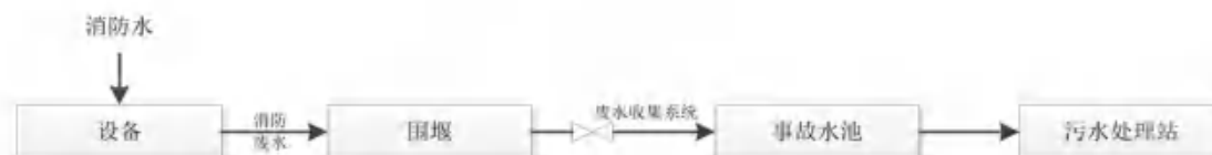
图 5.3-5 燃烧时消防废水传输图
