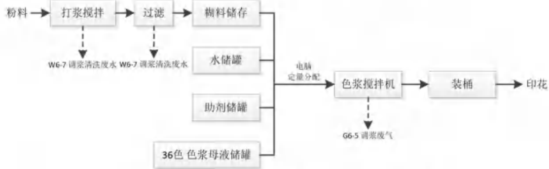
图 3.3.2-8 自动调浆细化工艺流程图及产污环节图
