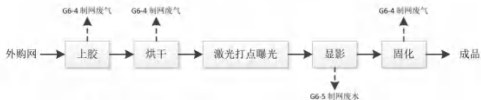
图 3.3.2-9 圆网蓝光制网细化工艺流程图及产污环节图
